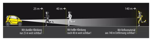
Reflektierende Materialien leuchten im Abblendlicht auf und ermöglichen dem Autolenker rechtzeitig zu reagieren und Unfälle zu vermeiden.
